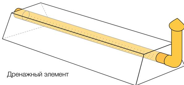
Дренажный элемент представляет собой ёмкость формы усеченной пирамиды без дна, располагающуюся на подушке из щебня. Через всю длину проходит дренажная труба посредством которой самотеком сбрасывается вода.
