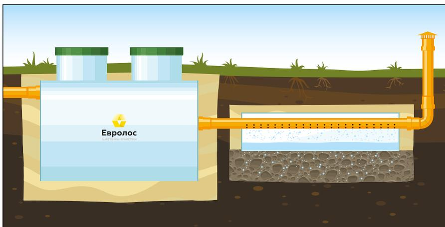
**Вариант 1.** Монтаж с применением дренажного элемента, при низком уровне грунтовых вод от 1,5м и ниже.
