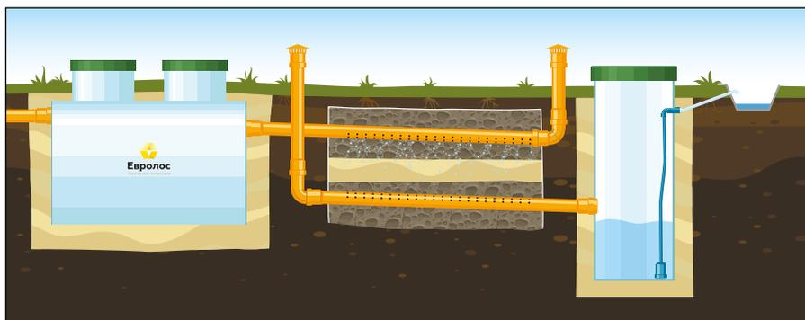
**Вариант 6.** Используется при очень плотных плохо впитывающих либо невпитывающих грунтах.
